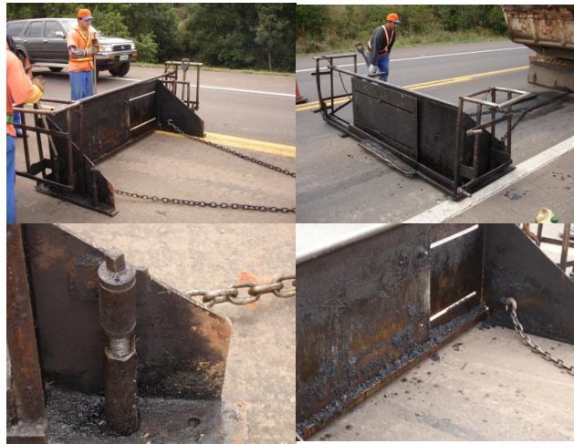
Figura 3 – Dispositivo de nivelamento regulável em altura e largura
